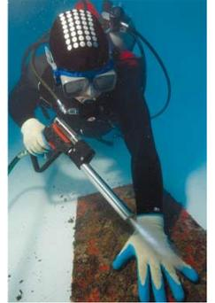
CaviBlasterは、従来の超高圧ジェットより低い圧力で動作させるので安全で、表面のコーティングを傷める心配がありません。
